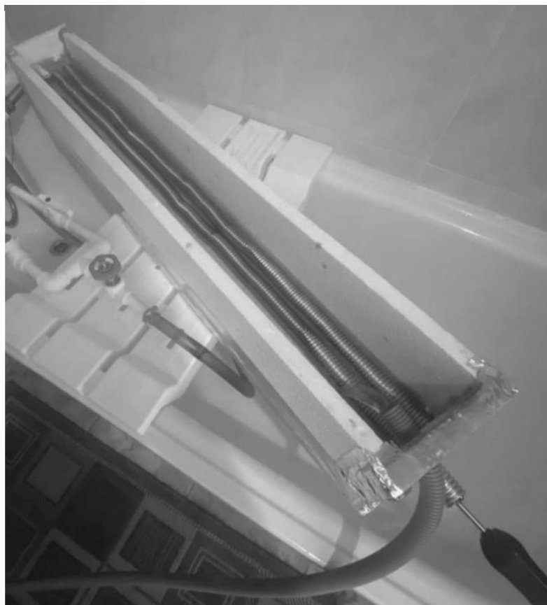
Рисунок 3.1. – Экспериментальная установка «Исследование теплопередачи в утилизационном теплообменнике»
