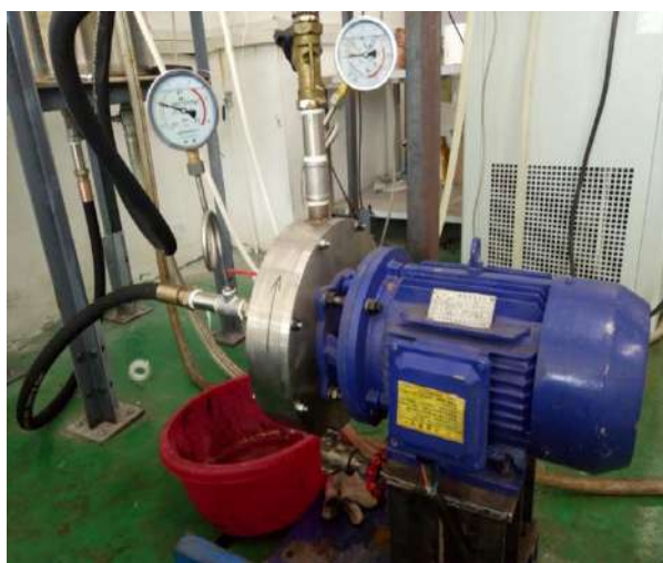
Рисунок 3.5 – Суперкавитационный стенд [404] – Схема установки для гидродинамических исследований: 1, 7 – патрубков для подвода жидкости; 2, 5 – лопатки; 3 – корпус; 4 – кавитатор в виде крыльчатки; 6, 8 – полукольцо с петлеобразными выступами; 9 – вал кавитатора; 10 – выходной патрубок (Китай)
