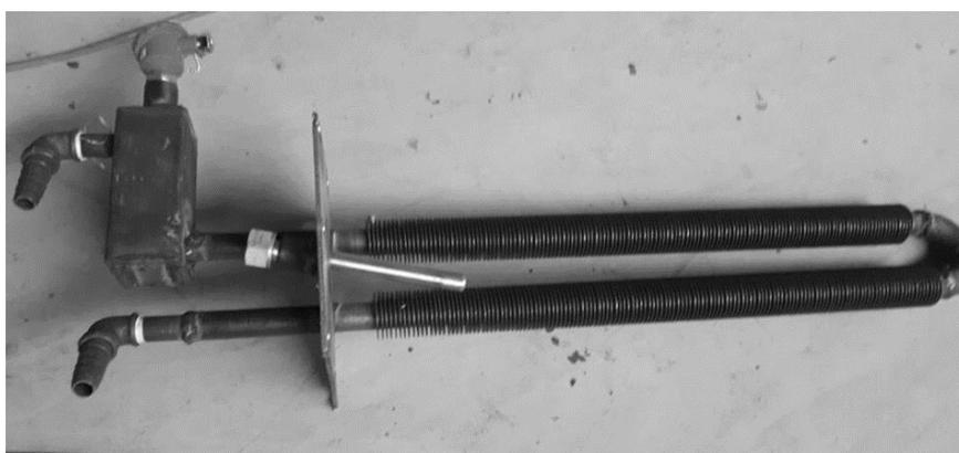
Рис. 3.6. Фото исследуемого модуля, который был установлен в трубопровод, по которому протекала парогазовая смесь
