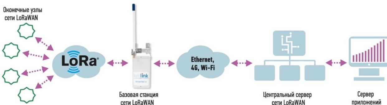
Рисунок 3 - Архитектура дистанционной передачи данных с использованием технологии LoRaWAN (оконечные узлы – микроконтроллеры, подключенные к теплосчетчикам)
