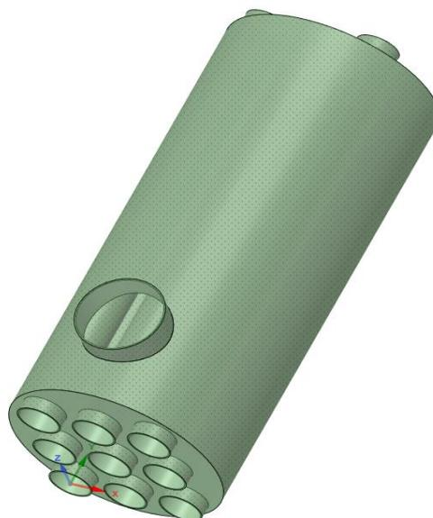
Рис. 3.29. Трехмерная модель теплообменника с входным патрубком
