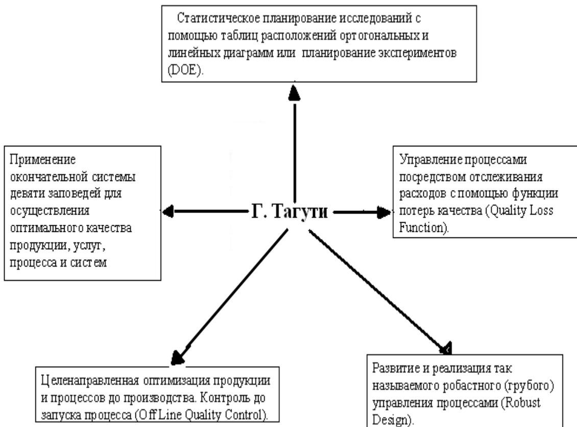
Рис. 8. Основные методы и идеи, разработанные или адаптированные Г. Тагути.
