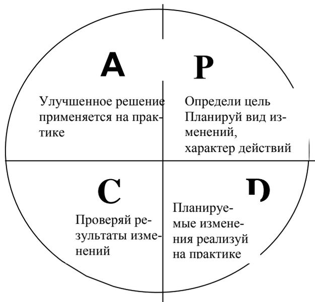
Рис. 3. Цикл непрерывного совершенствования Шухарта – Деминга [20]
