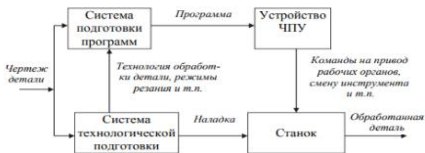
Рис. 1.1. Комплекс числового программного управления
