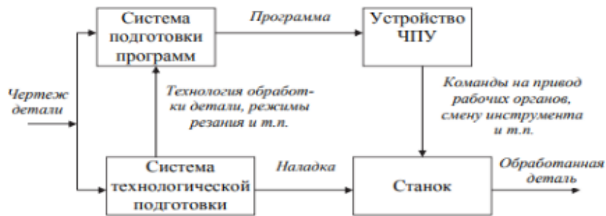
Рис. 1.1. Комплекс числового программного управления
