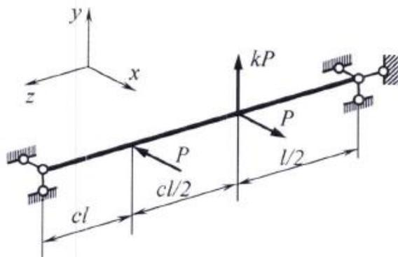
4. Найдите допускаемое значение параметра нагрузки  $P$  с учетом возможной потери устойчивости сжатых стержней.
