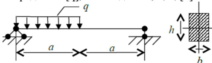
8. Определить угловое перемещение крайнего левого сечения балки для заданного  $q$ , если  $a, b, h, [s]$  заданы.
