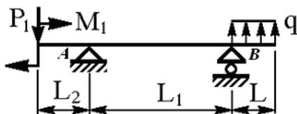
3. А. Найдите опорные реакции и построьте эпюры изгибающих моментов  $M_x$  в вертикальной плоскости,  $M_y$  в горизонтальной плоскости.
