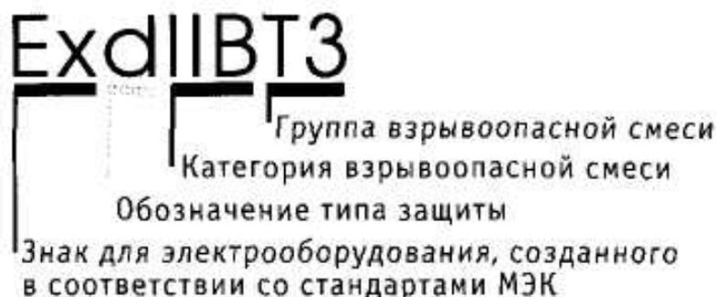
В маркировке по взрывозащите электрооборудования категории II, предназначенного только для конкретной взрывоопасной смеси, после знака
