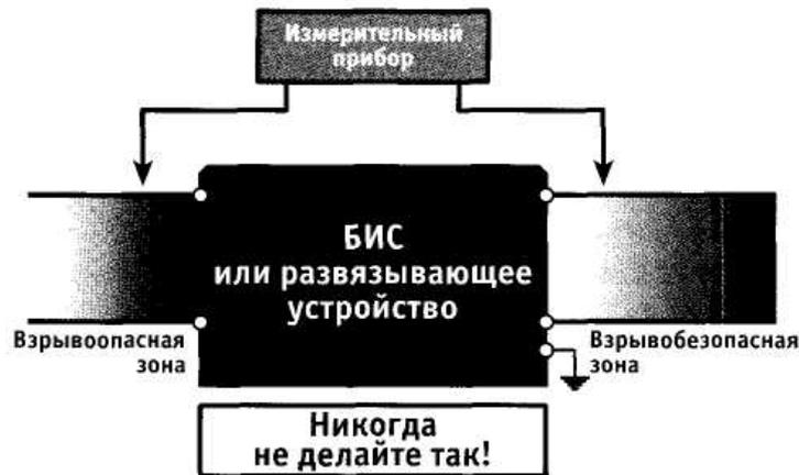
Рис. 12.13. Запрещенный вариант обслуживания БИС или развязывающего устройства, включенного в схему
