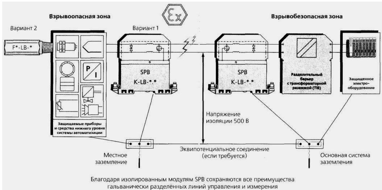
Рис. 13.6. Применение модулей *SPB* с электрическими аппаратами, приборами и другими средствами автоматизации, установленными во взрывоопасных зонах
