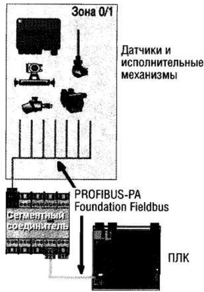
Рис. 12.15. Подключение оборудования взрывоопасной зоны через систему удалённого ввода-вывода
