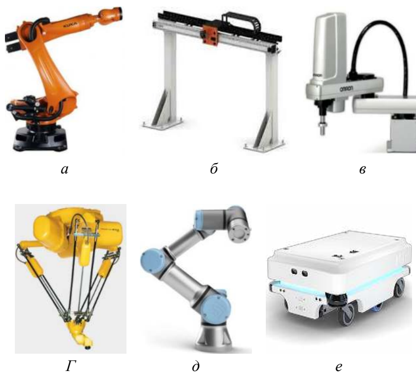
Рис. 1. Виды роботов: а – робот-манипулятор; б – порталный робот; в – Scara-робот; г – Дельта-робот; д – коллаборативный робот; е – мобильный робот
