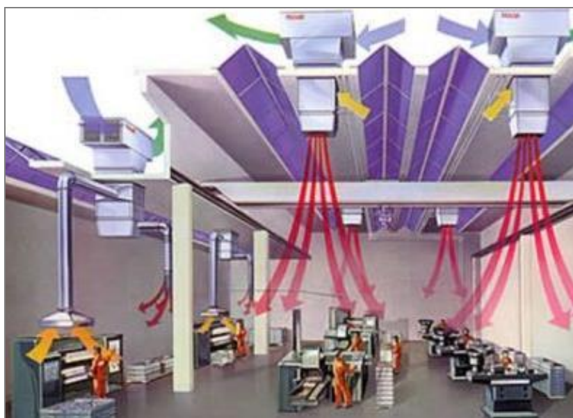
Рис. 4.3. Общеобменная канальная вентиляция
