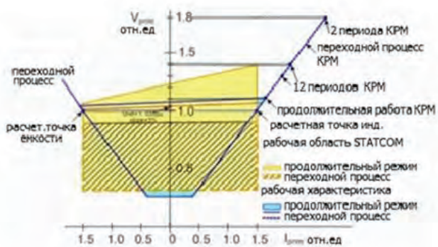
Рисунок 11 – ВАР тиристорного КРМ и КРМ на преобразователе напряжения
