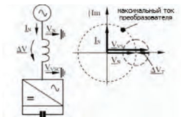
Рисунок 10 – Принцип работы преобразователя напряжения
