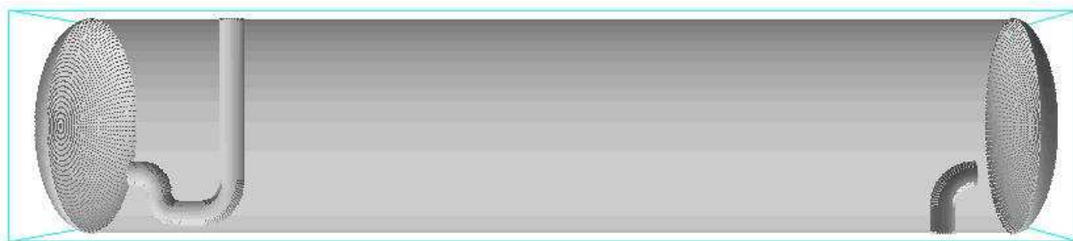
Рис. 2.5. Вариант модернизации гравитационного отстойника
