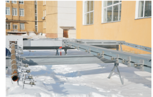
Рис. 4. Механические испытания опоры ЛЭП на испытательном полигоне КГЭУ
