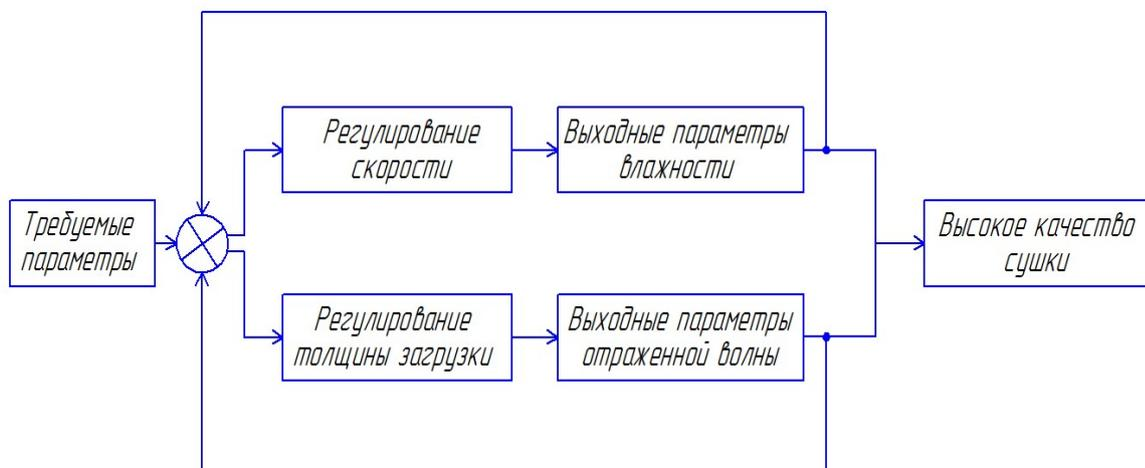
Рис. 3. Вариант реализация системы управления конвейерной СВЧ установкой
