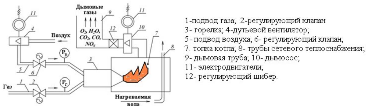
Рис. 2. Технологическое оборудование котла (упрощенная схема)
