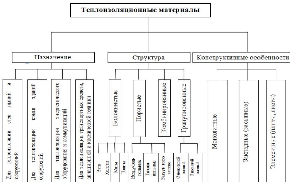
Рис. 1. Классификация теплоизоляционных материалов
