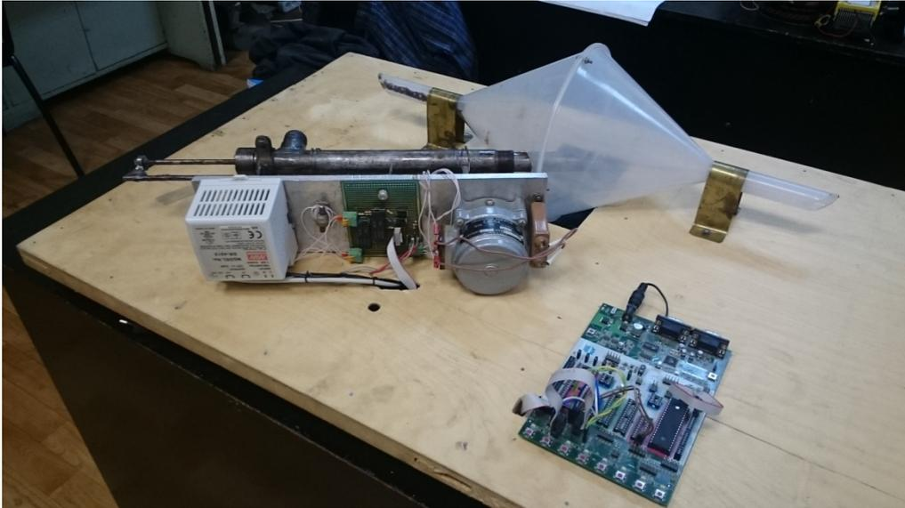
Рис. 3. Стенд анализатора второго поколения ЯМРА II
