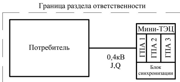
Рис. 2. Локальная изолированная газовая энергоэффективная электротеплогенерирующая система (владелец – потребитель)
