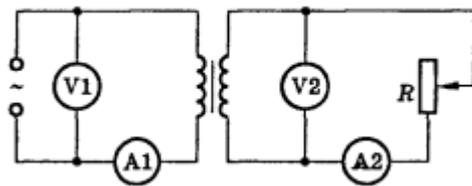
В процессе работы увеличивается полезная нагрузка. Опишите как изменятся показания амперметра A2 и вольтметра V1.
