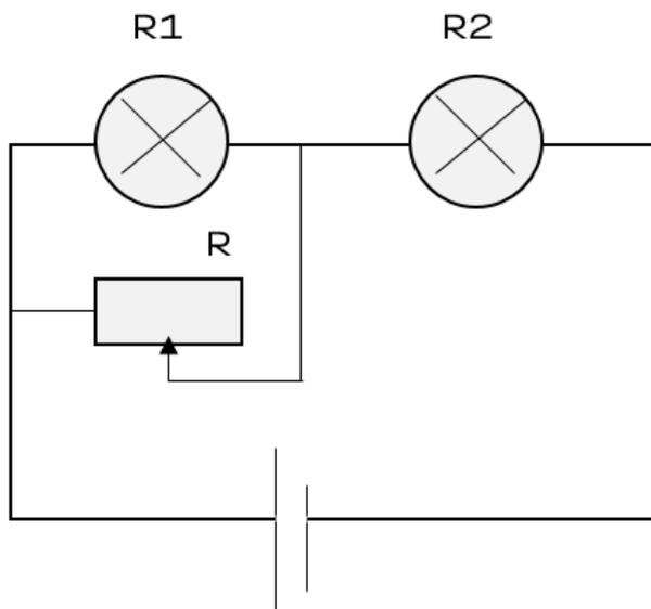
$$U = 6 \text{ В}, R = 30 \text{ Ом}, U_1 = 3,5 \text{ В}, I_1 = 0,35 \text{ А}, U_2 = 2,5 \text{ В}, I_2 = 0,5 \text{ А}$$
