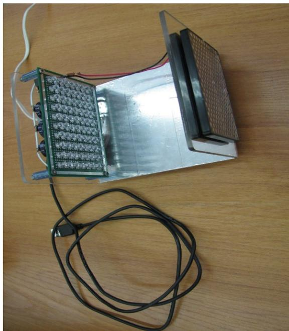
В случае работы устройства в режиме автоматизированной обработки полученных данных, например с применением ЭВМ, появляется возможность сопоставительного сравнения характеристик солнечных элементов в условиях изменения режима освещения. Устройство достаточно просто по конструкции, имеет незначительное количество комплектующих элементов и поэтому стоимость ее невысокая. Научная прора-
