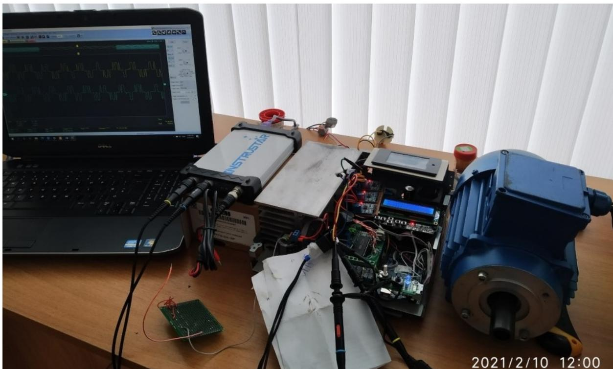
Рисунок 3.22. Внешний вид аппаратно-программного комплекса для исследования электродвигателей с комбинированной обмоткой
