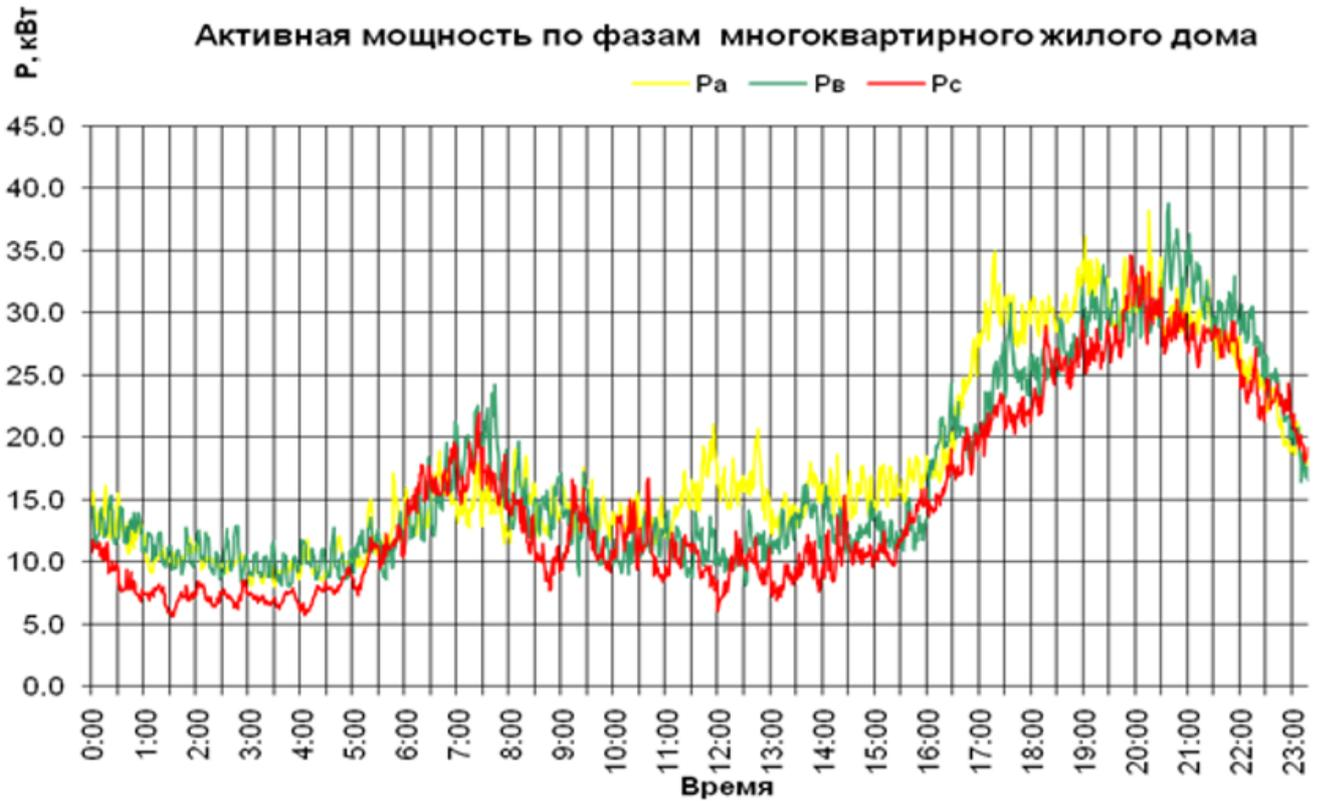
Рис. 2.1.- График пофазного потребления активной мощности многоквартирного жилого дома
