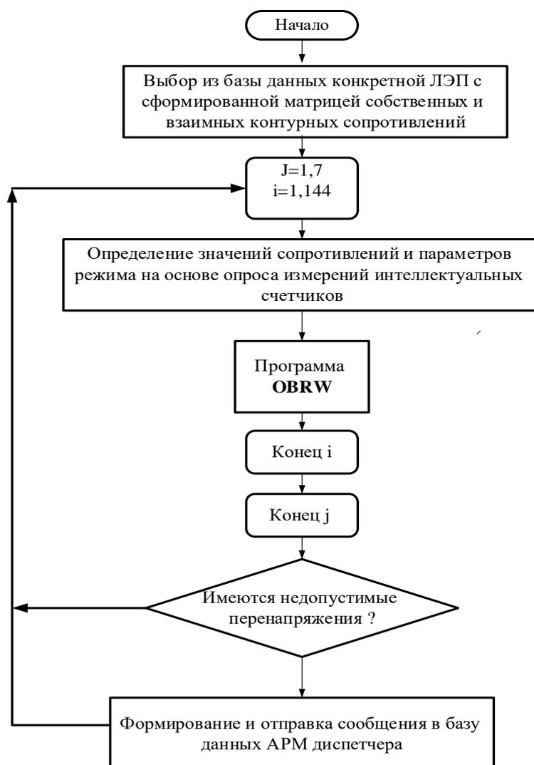
Рис. 3.12. – Блок-схема алгоритма определения недопустимых перенапряжений
