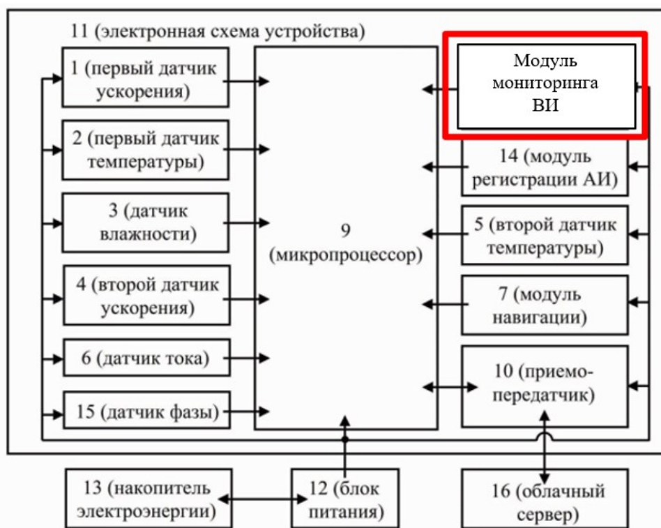
Рис. 3.8. Структурная блок-схема модернизированного устройства системы СМГ-16, модуль мониторинга ВИ представлена на рис. 3.1
