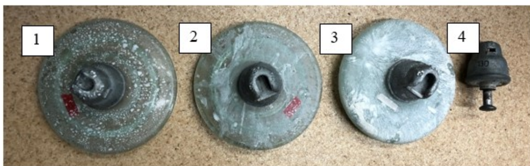
Рис.2.31. Искусственно загрязненные изоляторы и разбитый изолятор:
