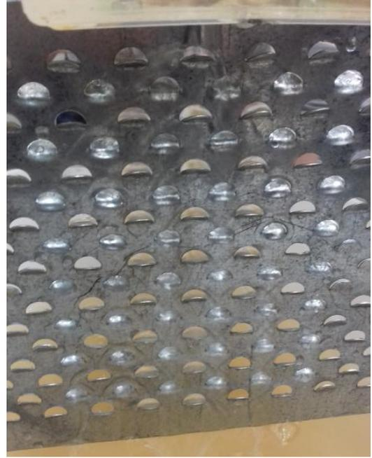
Рис. 2.14 Схема течения воды по пластине при расстоянии между лепестком и емкостью  $l = 40$  мм;  $h$ , мм: 1 – 6; 2 – 13; 3 – 50.
