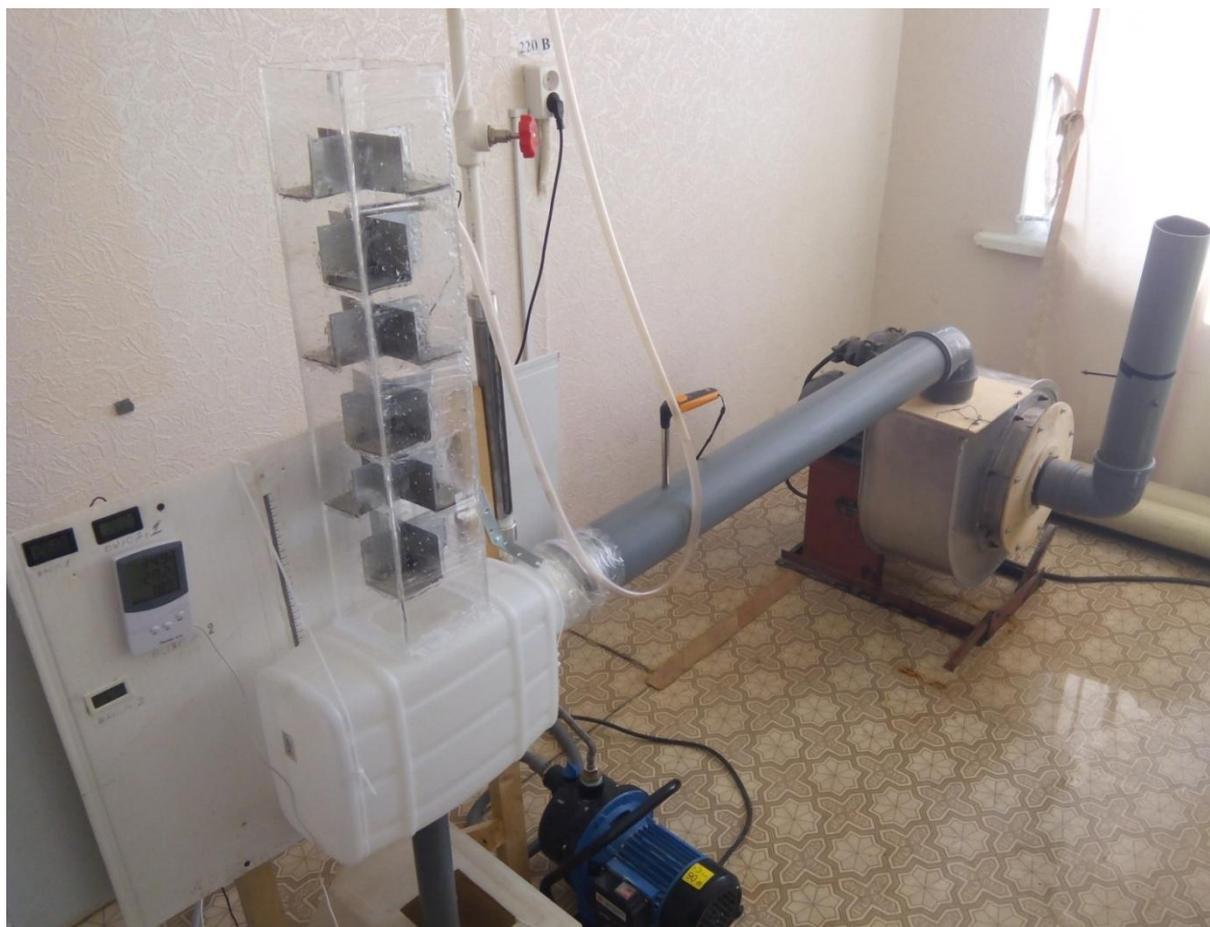
Рис. 5.6 Общий вид экспериментальной установки для исследования гидравлических и теплообменных характеристик струйно-пленочных контактных устройств
