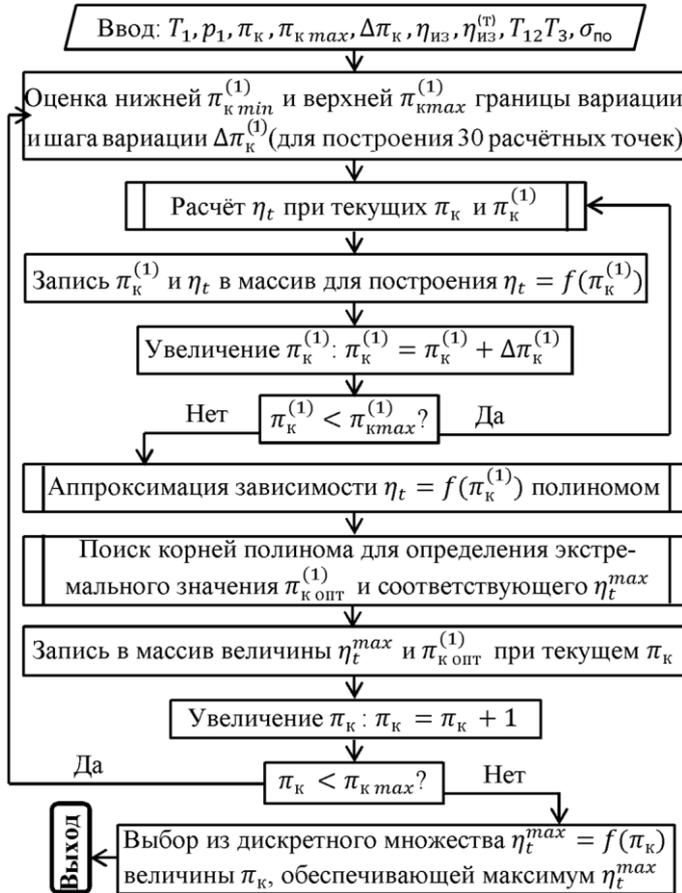
1) тепловым расчётом изучается зависимость  $\eta_t$  или  $L_{\text{П}}$  от первого управляющего параметра  $\pi_k^{(1)}$  – при различных фиксированных значениях  $\pi_k$ . Оптимум управляющего параметра определяется аппроксимацией полиномом расчётных точек и изучением многочлена на максимум.
