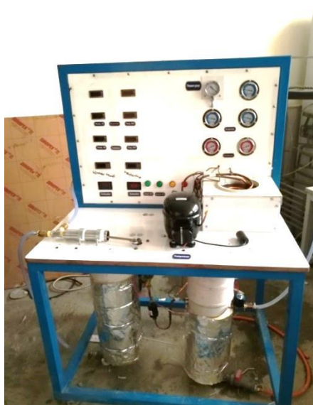
Рис 4.28 – Прототип системы дистилляции воды, построенный в инженерно-техническом колледже Мосула– Северного технического университета в Ираке
