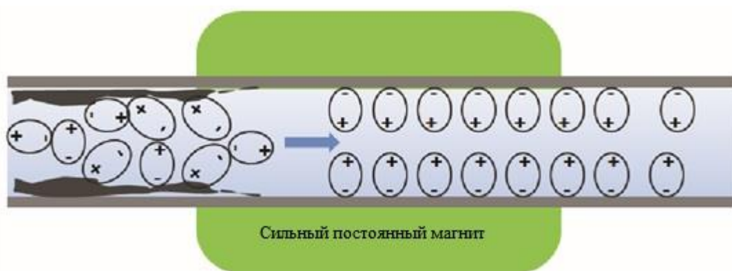
Рис 1.11 –Влияние магнитного поля на жесткую воду
