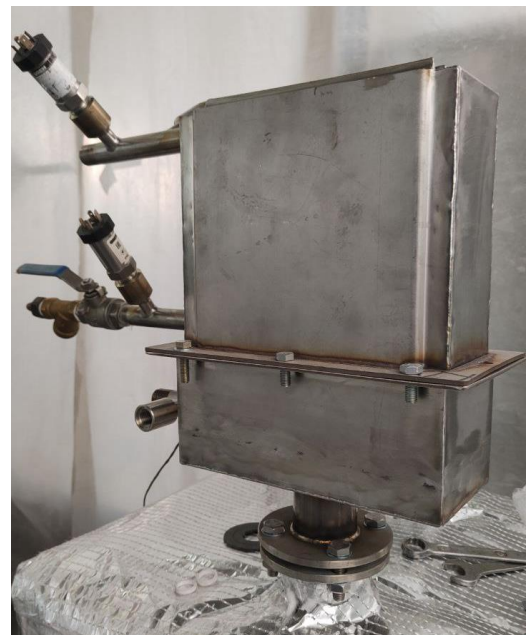
Рисунок 4.8 Общий вид пластинчатого теплообменника 1 – Выход теплоносителя; 2 – вход теплоносителя; 3 – вход пара; 4 – выход конденсата; 5 – датчики давления; 6 – датчики температуры
