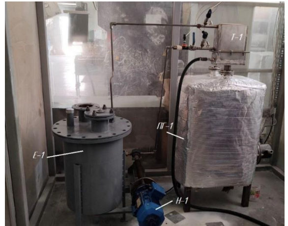
Рисунок 4.7 Стенд для исследования процесса нагрева гидравлического масла паром без/с интенсификаторами: E-1 – емкость гидравлического масла, ПГ-1: парогенератор, E-2 – приемная емкость масла, T-1 – пластинчатый теплообменник, TE – измерение температуры, FE – измерение расхода, PT – измерение давления
